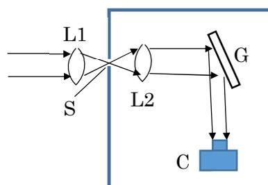
図 1 高速分光装置 L1: 集光レンズ、
